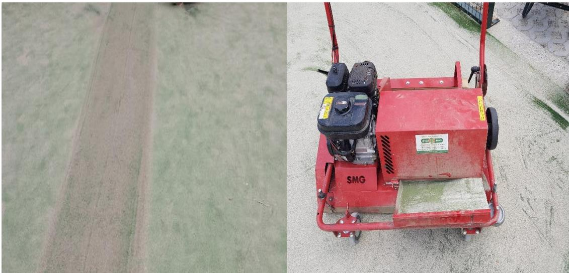
**PHASE 2 :** Décompactage de la surface. Il permet d'ouvrir parfaitement le gazon synthétique et de remonter le sable et les pollutions à la surface du court.
