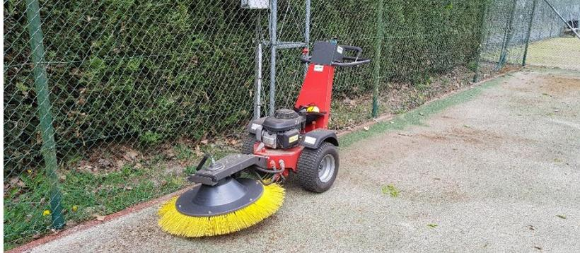
**PHASE 5 :** Sablage du court et brossage oscillant pour permettre une parfaite intégration du sable dans le gazon synthétique nettoyé.
