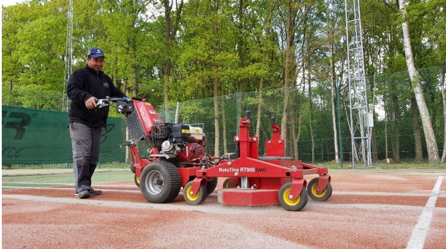
**PHASE 3 :** Filtration du sable et séparation des pollutions qui sont récupérées dans le bac de filtration de la machine.
